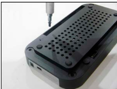
3. Затяните винты внизу корпуса HDD для фиксации жесткого диска (короткие винты, 4 шт.)
